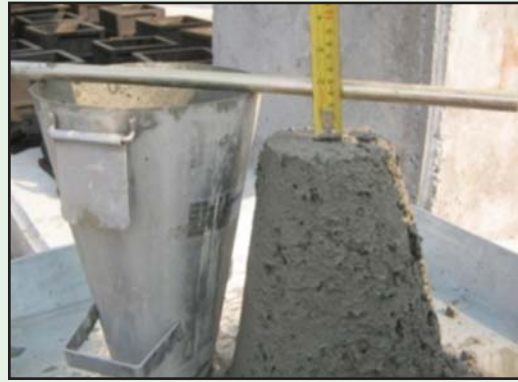
รูปที่ 3-17 การตรวจสอบค่าการยุบตัว (Slump Test)
