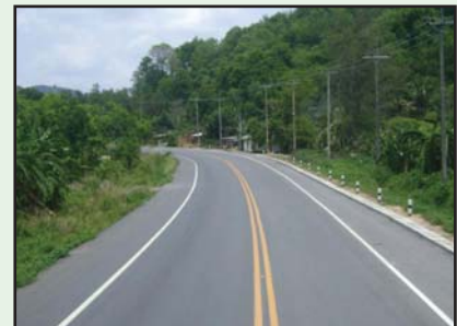
รูปที่ 7-14 สีที่ทาถนนผิวจราจรจะต้องคงอยู่ และสะท้อนแสงได้ดีภายใต้สภาพการจราจรปกติ ไม่น้อยกว่า 24 เดือน
