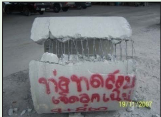
รูปที่ 5-6 การทดสอบท่อโดยการบีบอัดด้วยเครื่อง และตรวจสอบการเสริมเหล็ก
