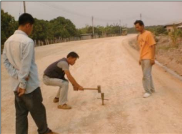
รูปที่ 4-35 การใช้เหล็กเจาะ เพื่อตรวจสอบความหนาแน่นวัสดุ
