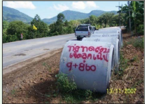
รูปที่ 5-5 ทำเครื่องหมายบนท่อที่สุ่มเก็บตัวอย่าง เพื่อทดสอบ
