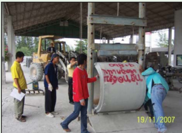
รูปที่ 5-6 การทดสอบท่อโดยการบีบอัดด้วยเครื่อง และตรวจสอบการเสริมเหล็ก
